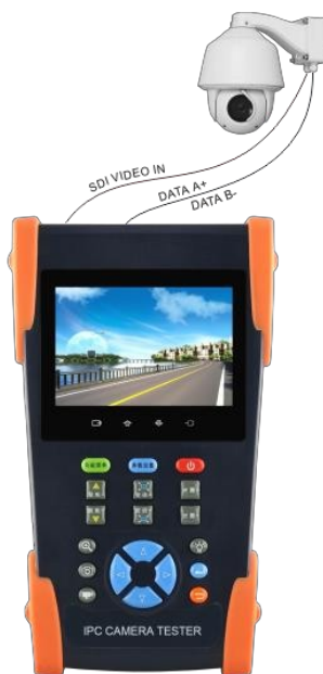
Рис 3.2.3-1 Подключение тестера к аналоговой камере высокого разрешения.
