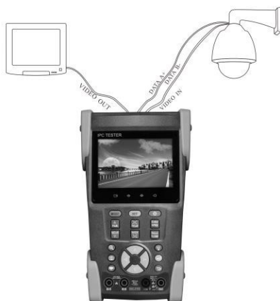
Рис 3.2.2-1 Подключение тестера к аналоговой камере.
