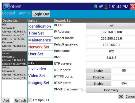
Рис.3.3.3-10 Сетевые установки (настройки IP протокола)
