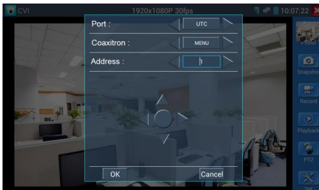
Рис.3.3.6.-5 Установка параметров протокола Coaxitron
