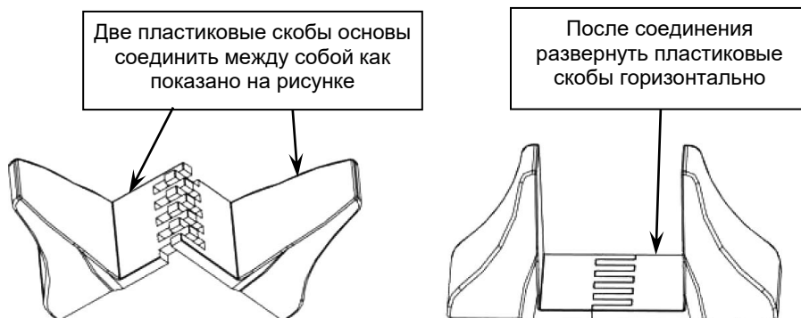
Рисунок 3 - Сборка пластиковых основ для вертикальной установки изделия.
