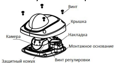
Рисунок 1-23 Настройка угла наблюдения камеры
