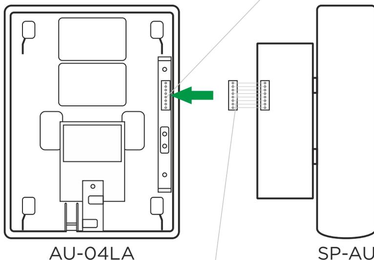
Разъем подключения к монитору
