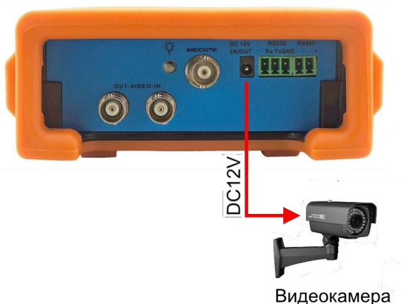
Рис. 7 Подключение питания к IP-видеокамере
