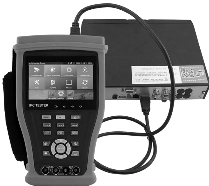
Рис. 10 Подключение HDMI устройств к тестеру.
