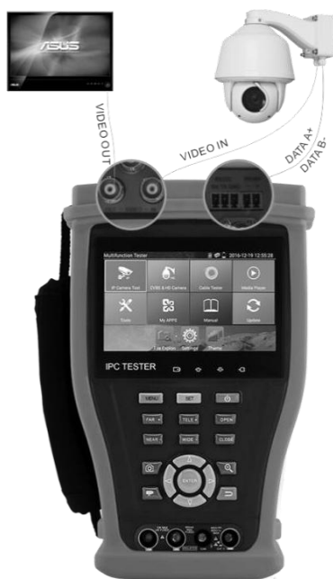
Рис. 8 Подключение CVBS видеокамеры к тестеру
