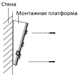
Рисунок 2-8 Установка наклонной монтажной платформы
