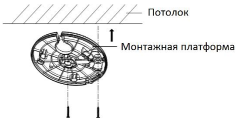
Рисунок 2-3 Установка монтажной платформы
