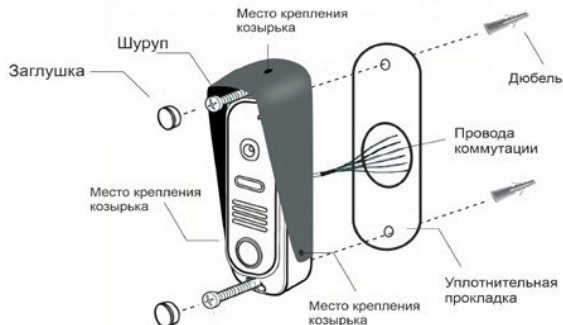
Монтаж вызывной панели с угловым кронштейном и без углового кронштейна
