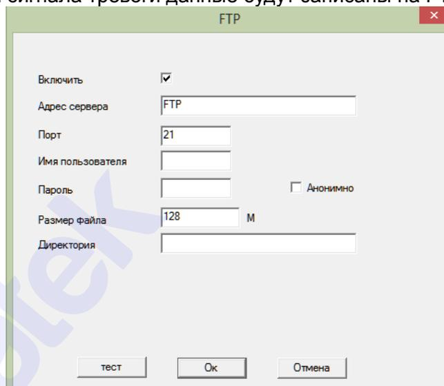
【Адрес сервера】 IP адрес FTP сервера.
