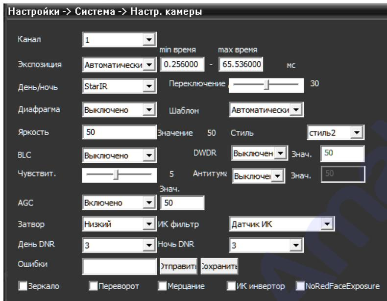
【Канал】 Номер канала (для IP камеры только 1-й канал).
