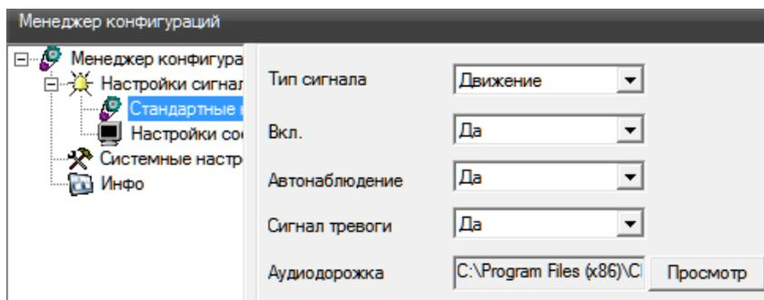
【Тип сигнала】 Тип сигнала тревоги или события.
