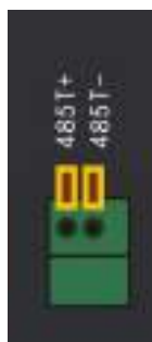
RS485 интерфейс 4 канального регистратора
