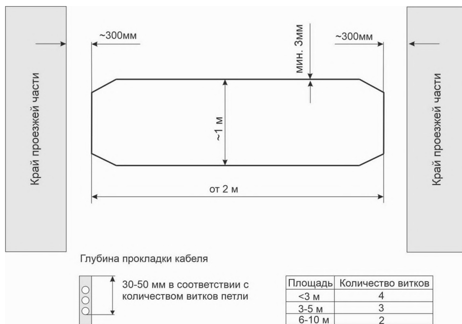
Рисунок 6.9.2.2 Схема монтажа петли
