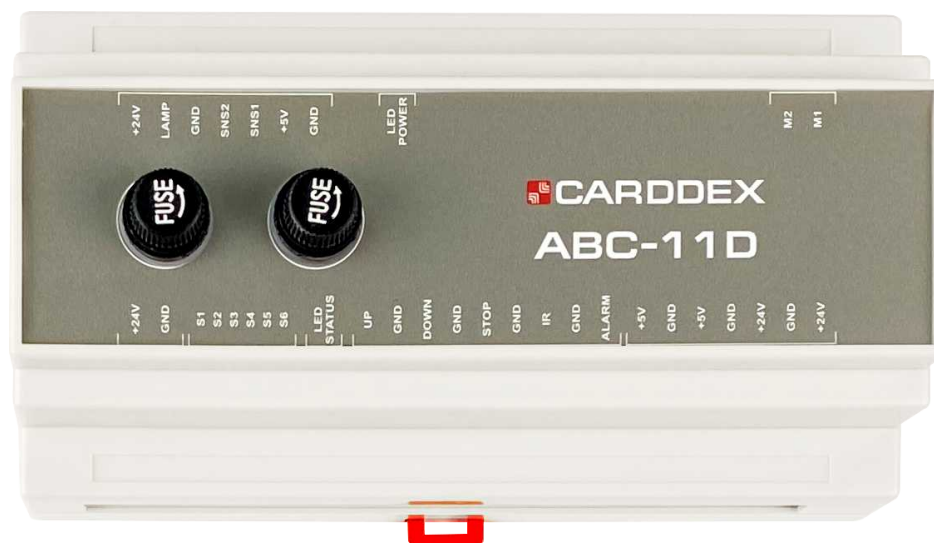
Рисунок 6.5.1 Электронный блок управления «ABC–11D»
