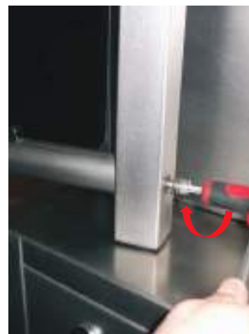
3. Затяните нижний винт
