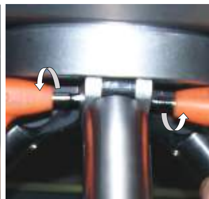
3. Затяните винты (шестигранник 5 мм)
