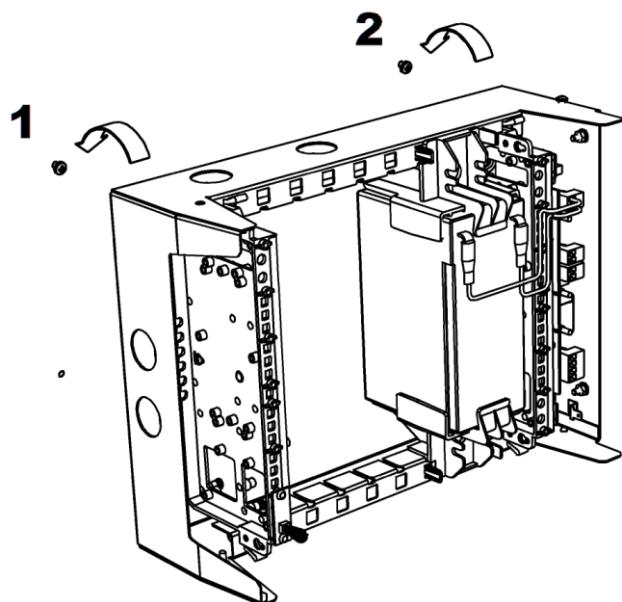
3. Для крепления изделия ввинтите шуруп в отверстие 3 и 4 в ее нижней части.
