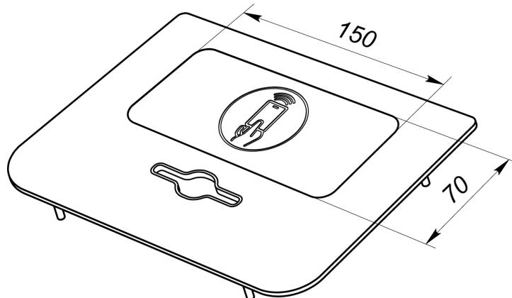
Рисунок 28. Внешний вид боковой крышки PERCo-C-10RC
