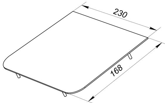
Рисунок 23. Габариты боковой крышки **PERCo-C-10B**
