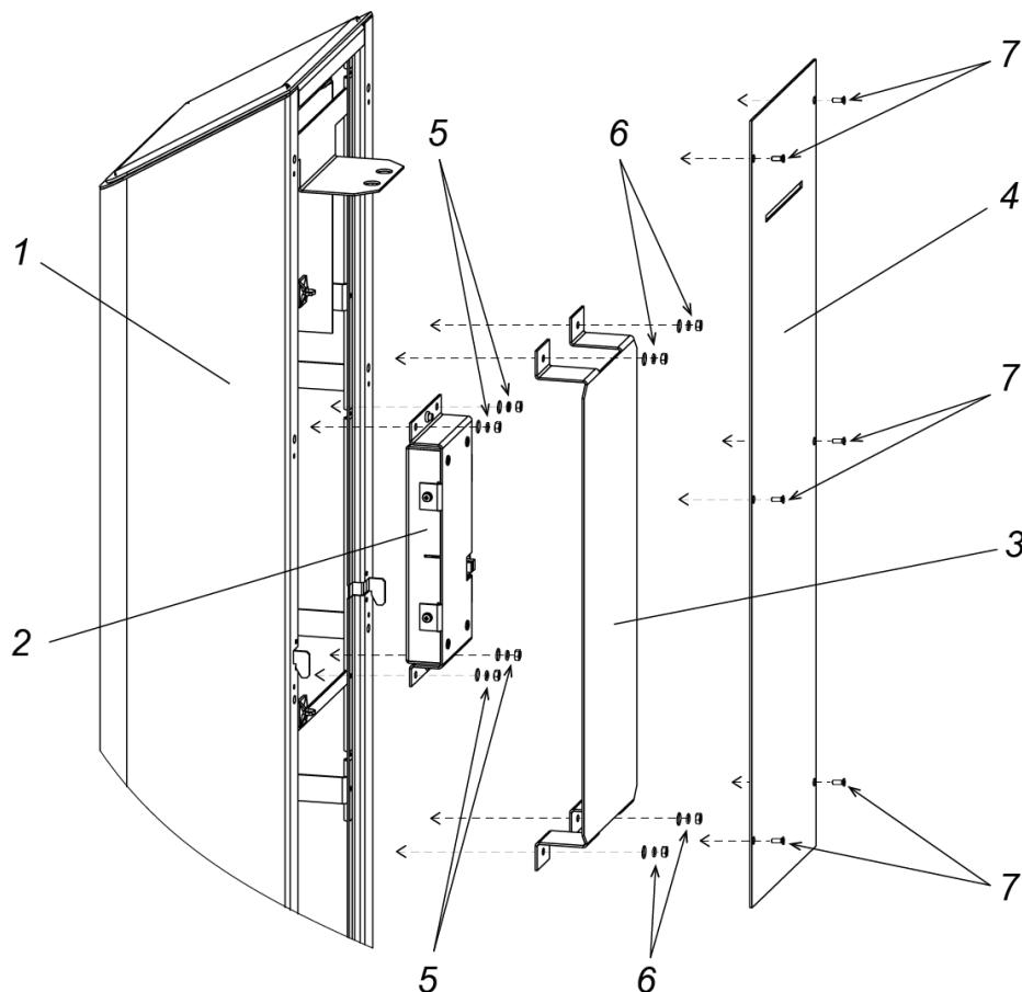
**Рисунок 20. Блок постоянной индикации стандартного бокового модуля**
