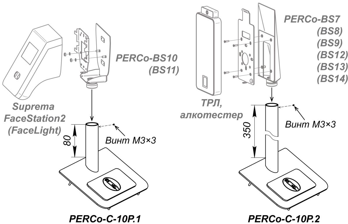
**Рисунок 25. Внешний вид боковых крышек PERCo-C-10P.1, PERCo-C-10P.2**
