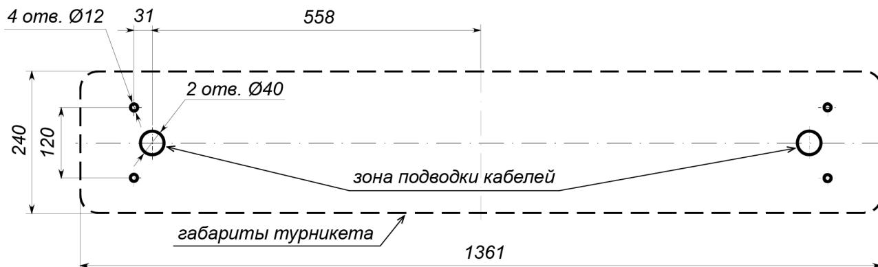
**Рисунок 18. Схема разметки для установки стойки турникета**
