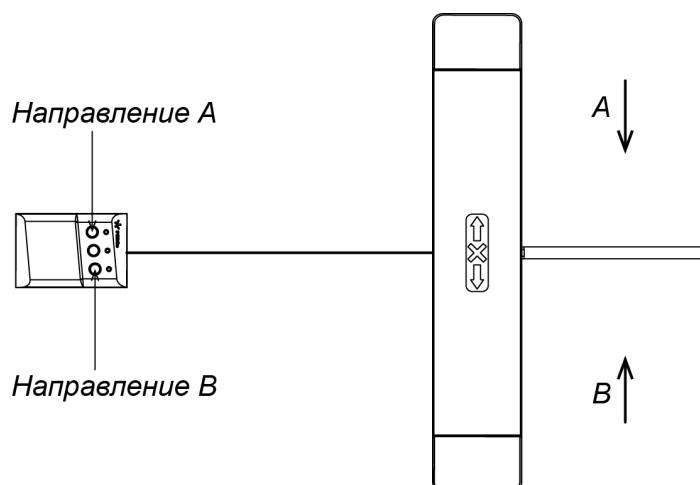
Рисунок 11. Стандартная ориентация ПДУ относительно стойки турникета
