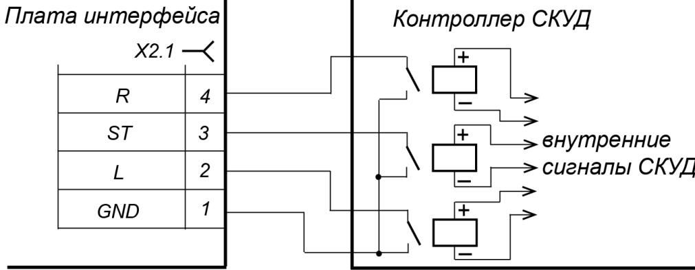
Рисунок 8. Управляющий элемент СКУД – нормально разомкнутый контакт реле
