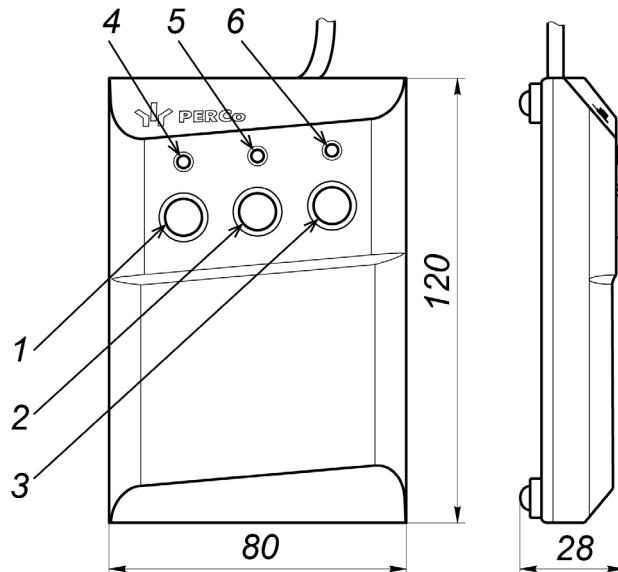
**Рисунок 6. Общий вид и габаритные размеры ПДУ**
