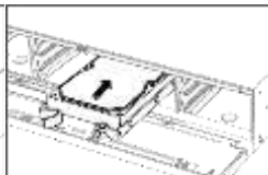
Рисунок 2-9 Вставьте жесткий диск
