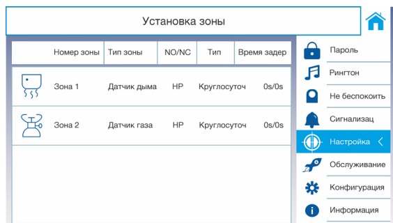
Рис.23 Настройка зон датчиков.
