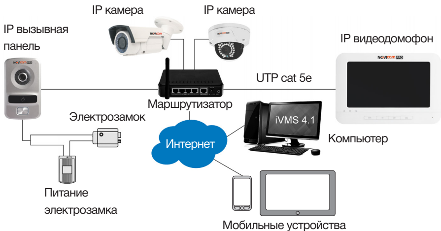
Рис.8 Пример схемы подключения NDM7F.
