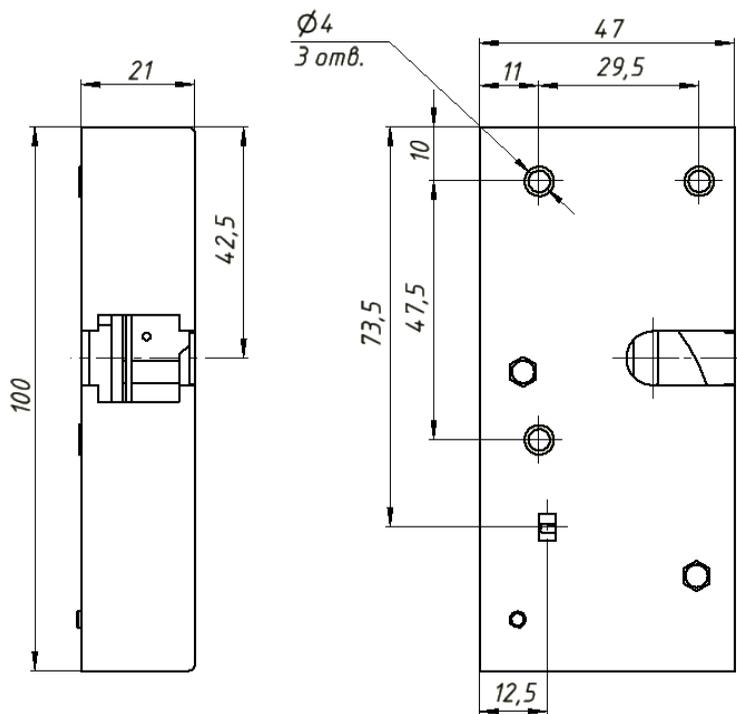
Рис. 3. Габаритные и установочные размеры замка Promix-SM326.
