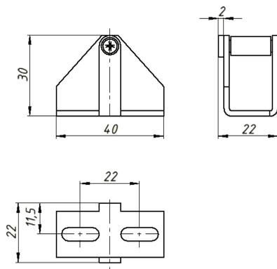
Рис. 2. Габаритные и установочные размеры ригеля Promix-AD.DB.21.
