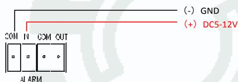
предназначены для подключения внешних датчиков и управляются подачей напряжения +5...+12В.
