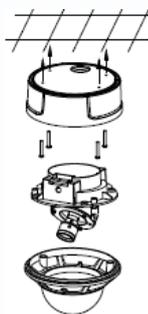
Вставьте шурупы из комплекта поставки в монтажные отверстия на днище камеры, прикрепите к днищу камеры резиновую прокладку из комплекта поставки камеры. Закрутите шурупы, прикрепив тем самым камеру. Камеру можно крепить как на потолок, так и на стену.
