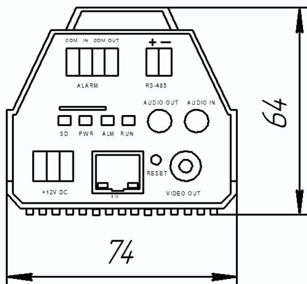
**+12V DC** (Разъем питания): разъем для подключения источника питания с постоянного напряжения 12 Вольт.
