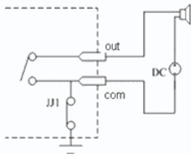
Контакты «COM» выход «-» «OUT» - выход «+». являются логическим выходом и предназначены для подключения внешнего устройства тревоги. Работают по принципу реле и срабатывают при возникновении какого либо события (детекция движения, сигнал тревоги от внешнего входа и т.д.).
