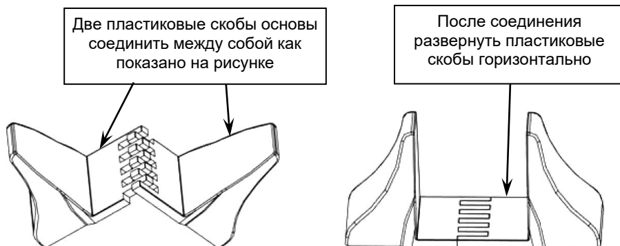
Рисунок 3 - Сборка пластиковых основ для вертикальной установки изделия.
