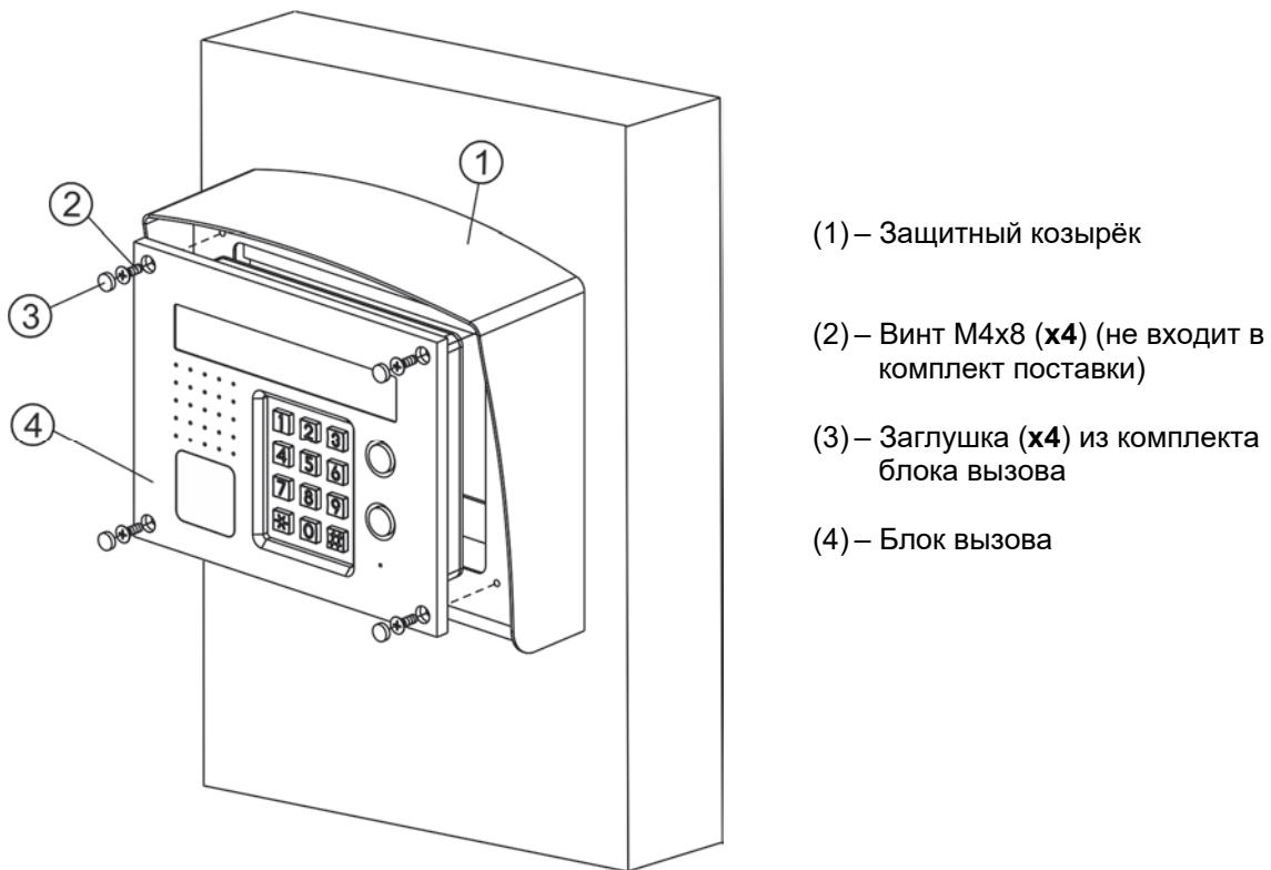
**Рисунок 6.4 - Установка блока на монтажный комплект МКФ-432**
