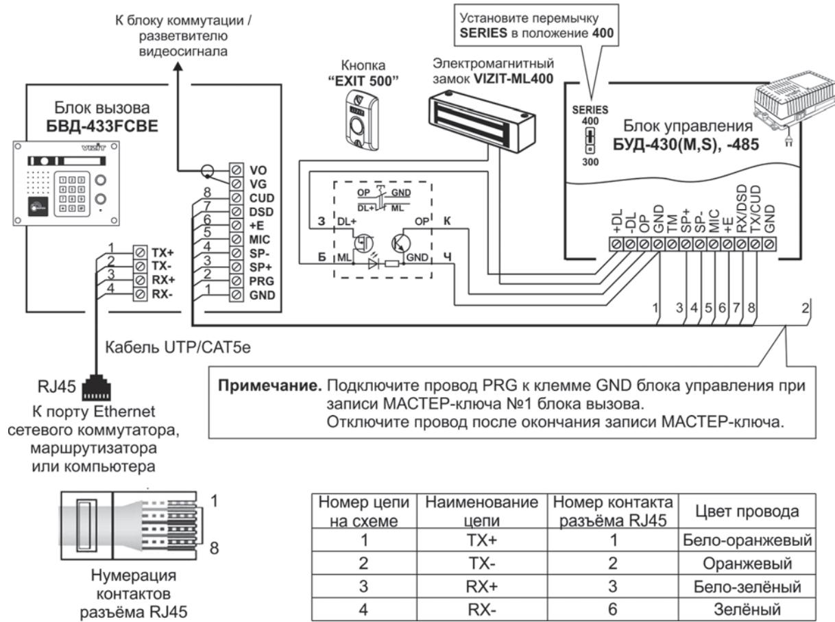
Рисунок 8.2 – Схема соединений блока вызова БВД-433FCBE с блоком управления БУД-430(M,S), -485(M), электромагнитным замком VIZIT-ML400 и кнопкой EXIT 500
