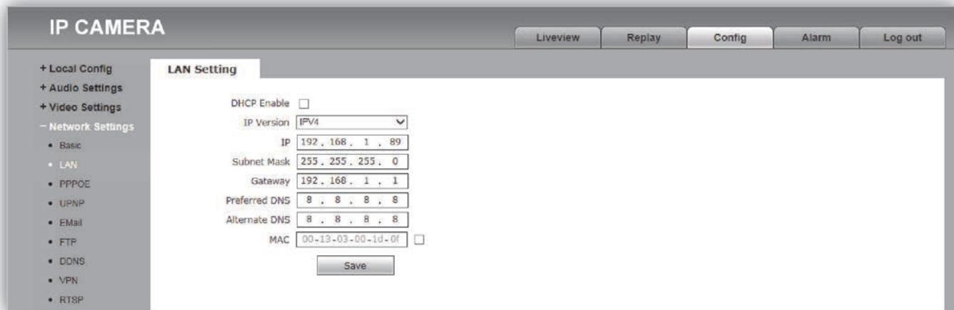
**Рисунок 14.11 - Окно Установки подключения к локальной сети (LAN)**
