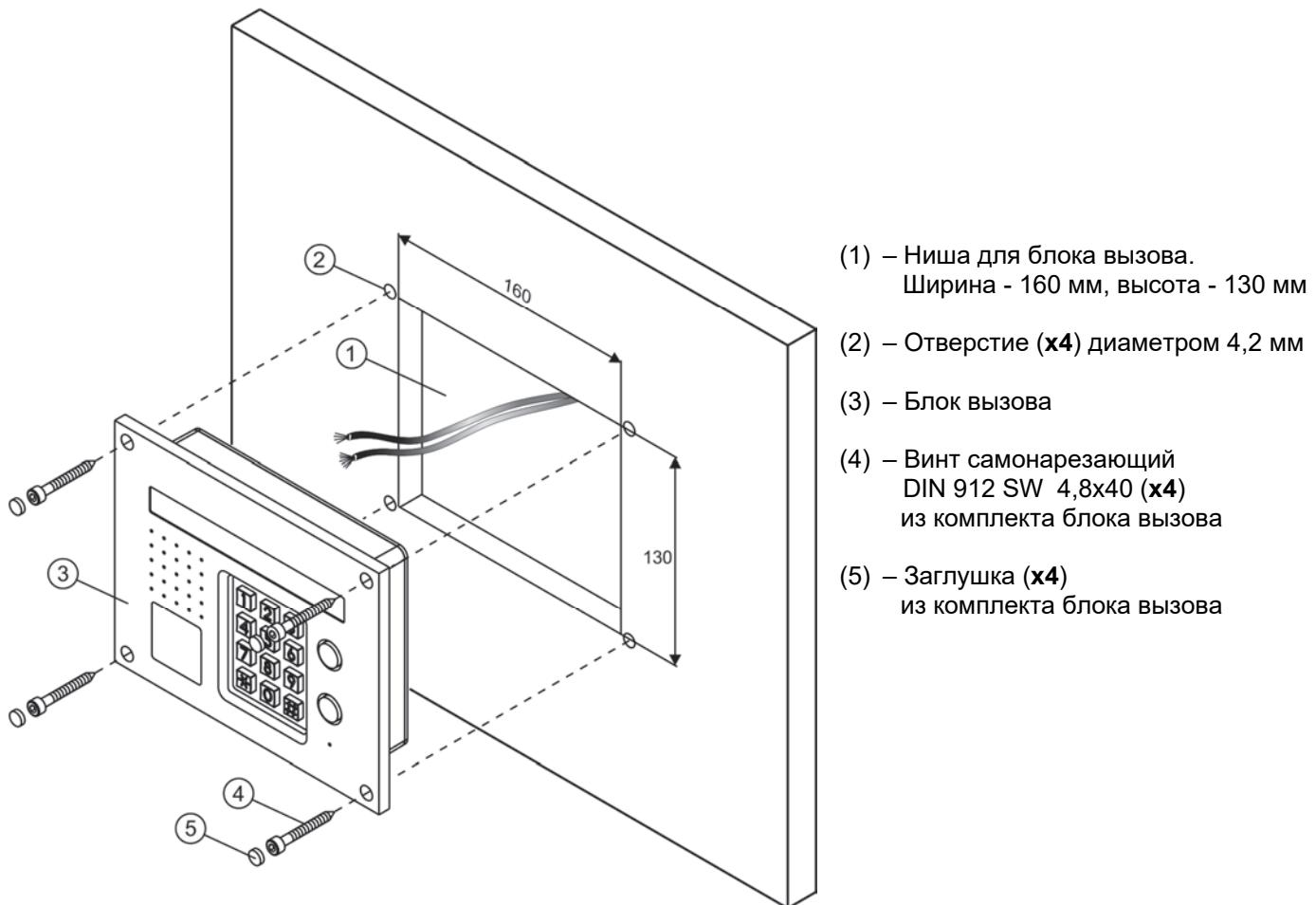
**Рисунок 6.2 - Установка блока вызова на наподвижной части металлической двери**
