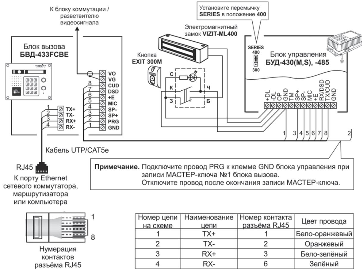
Рисунок 8.1 – Схема соединений блока вызова БВД-433FCBE с блоком управления БУД-430(M,S), -485(M), электромагнитным замком VIZIT-ML400 и кнопкой EXIT 300M
