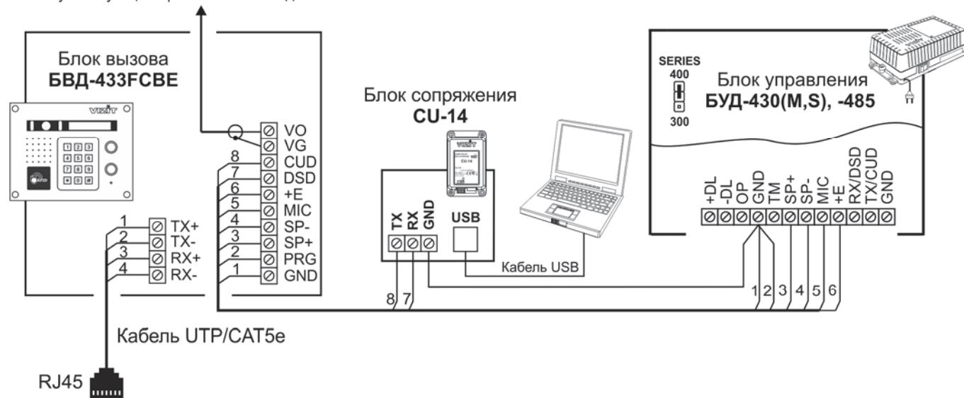
**Рисунок 15.1 - Схема соединений блока вызова с блоками управления БУД-430(S, M), -485 и блоком сопряжения CU-14**
