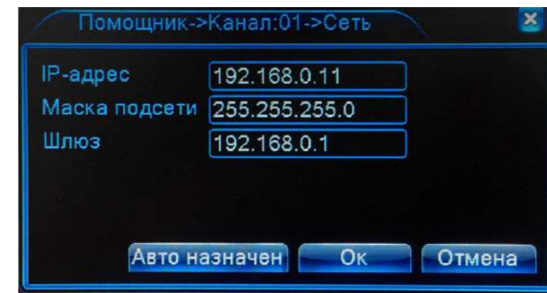
Рисунок 3.8 Установка сетевых параметров камеры.
