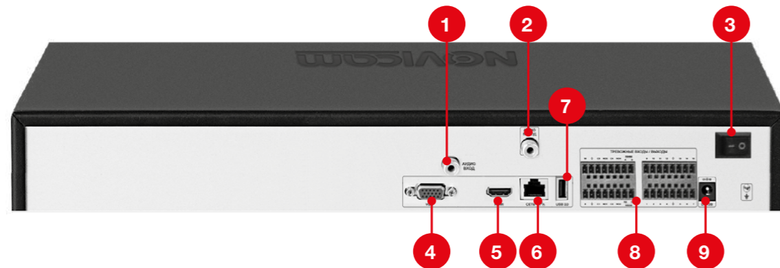
Рисунок 2.6. Задняя панель видеорегистратора NR4224.
