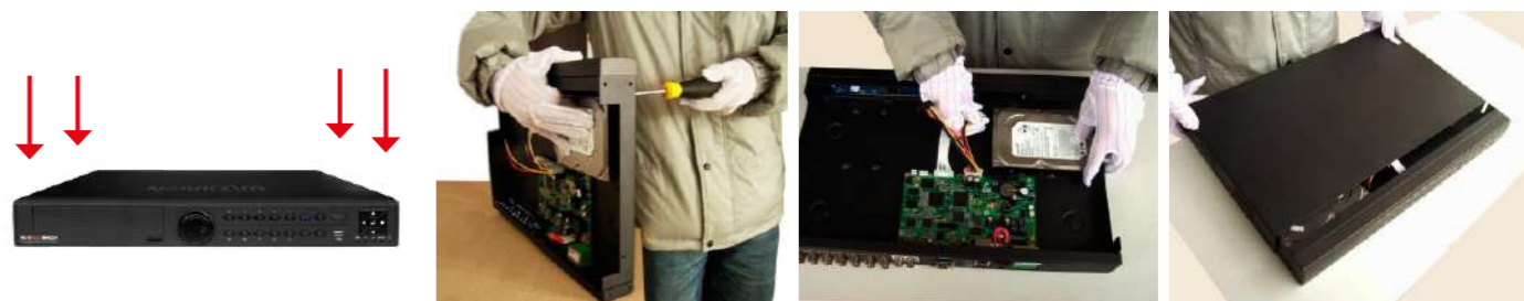
Рисунок 2.2. Установка жёсткого диска в видеорегистратор NR4224.
