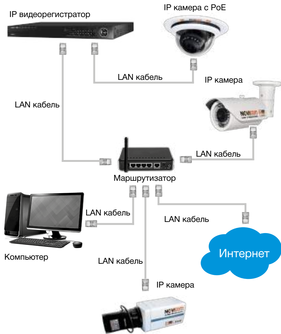
Рисунок 3.19 Подключение IP видеорегистратора с PoE.
