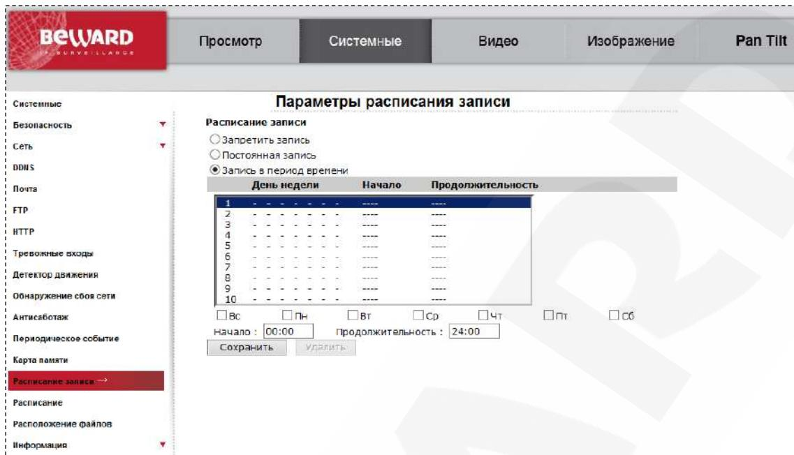
Благодаря постоянной записи видеороликов на карту памяти можно обеспечить запись видео даже при потере соединения с сетью, таким образом, камера может выполнять функцию автономного локального хранилища данных.
