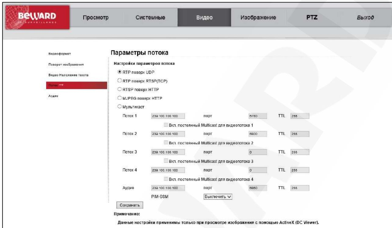
**RTP поверх UDP (RTP over UDP):** трансляция видео по протоколу RTP поверх протокола UDP. При выборе данного формата видео передается в потоковом формате без подтверждения приема пакетов. Такой формат передачи данных следует использовать только при работе камеры в слабо загруженных локальных сетях. Для передачи видео через Интернет такой формат вещания непригоден, так как большинство провайдеров фильтруют UDP пакеты и, кроме того, процент потерь таких пакетов в публичных сетях очень велик.
