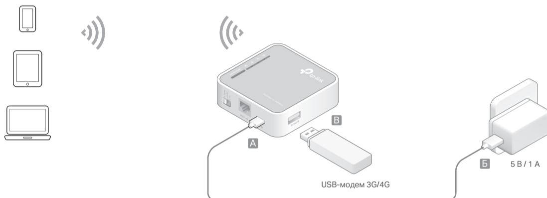
1. Измените режим работы на «3G/4G» и выполните подключение согласно схеме слева.
