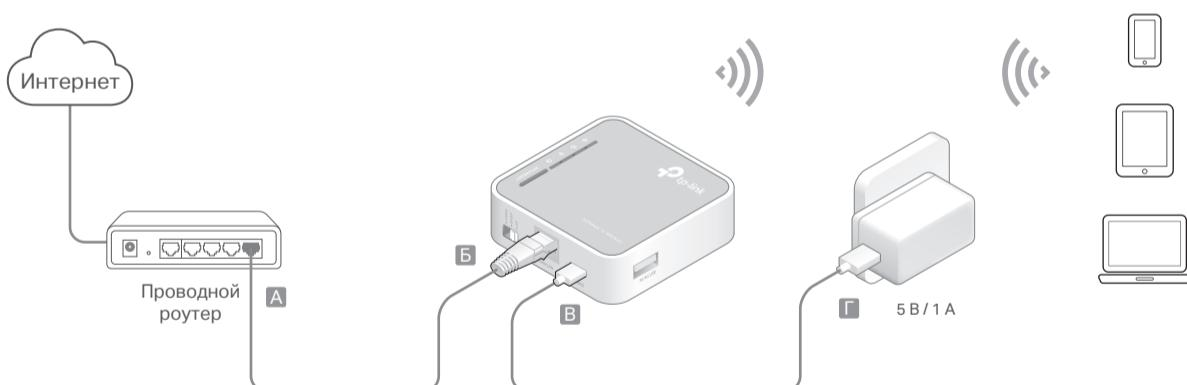
1. Измените режим работы на «AP» и выполните подключение согласно схеме слева.
