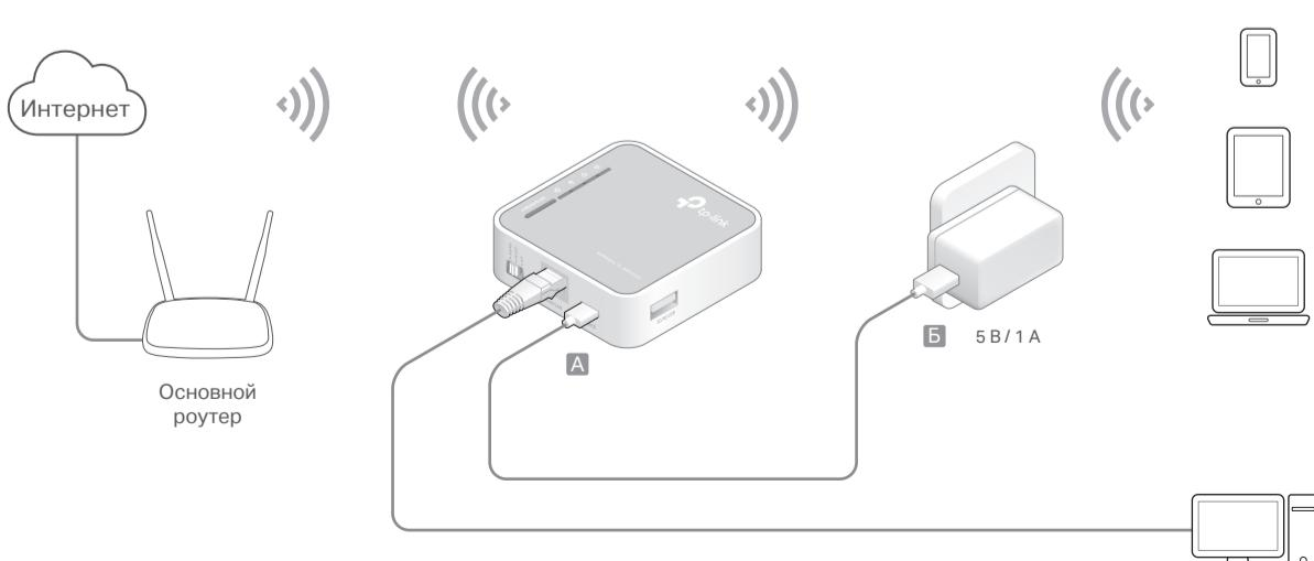
1. Измените режим работы на «AP» и выполните подключение согласно схеме слева.
