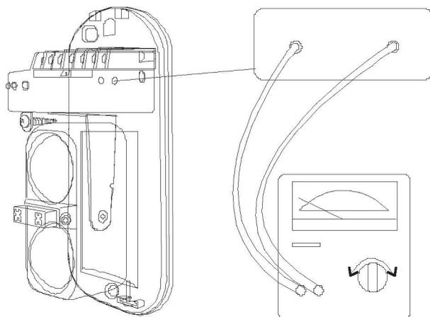
Наилучшая настройка положения оптической оси может быть достигнута при правильном подключении напряжения вольтметра.
