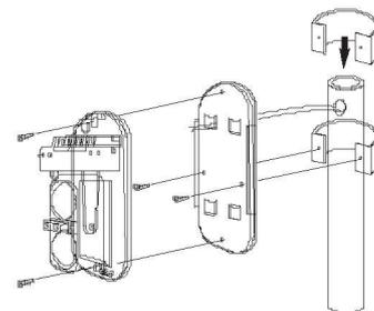
Схема установки двух датчиков на один кронштейны (спина к спине)
