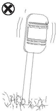
Монтируйте датчик на твердую устойчивую поверхность.
