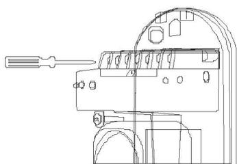
6. После корректировки времени отклика луча наденьте крышку на датчик.
