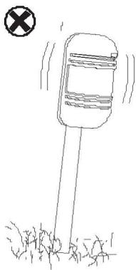
Монтируйте датчик на твердую устойчивую поверхность.
