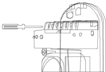
6. После корректировки времени отклика луча наденьте крышку на датчик.
