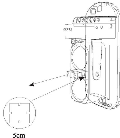
Яркость светодиода **LEVEL** (красный) приемника будет изменяться в зависимости от точности регулировки. Чем точнее регулировка, тем ярче горит светодиод.
