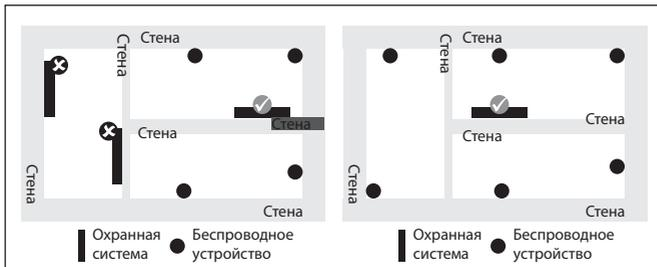
Очень важно обратить внимание на угол, под которым передаваемый сигнал достигает стены. Подходящая толщина стены - а также затухание сигнала - изменяется в зависимости от угла передаваемого сигнала. Передача сигналов через стену должна быть как можно более направленной.
