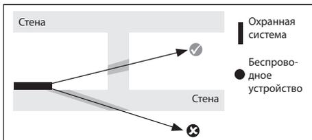
При использовании устройств с внутренней антенной-приемником, устройство должно быть установлено на той же стороне стены, что и передатчик. Рядом со стеной, радиоволны скорее всего будут отражаться или не смогут проникнуть сквозь стену. Соответственно антенна должна располагаться на противоположной или прилегающей стене.
