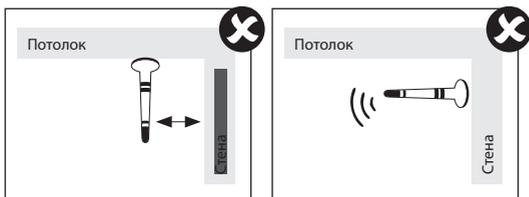
Массивные металлические предметы, такие, как металлические перегородки, металлические потолки, арматуры и фольга в теплоизоляционных материалах отражают электромагнитные волны и в связи с этим, может образовываться так называемая радиотень - область, недоступная для радиосигнала, создаваемая препятствиями на его пути. Однако небольшие отдельные металлические штыри, как например штыри в некоторых гипсокартонных стенах, радиосигналы не отражают.
