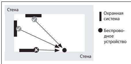
При использовании устройств с внешней антенной, идеальное расположение антенны - в центре охраняемого помещения. При возможности, антенну следует устанавливать на 10-15 см. от углов или бетонных потолков.
