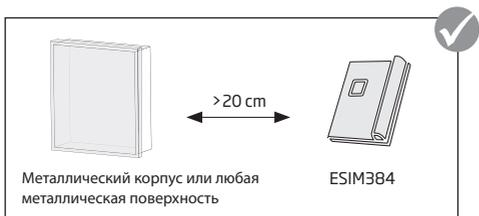
Металлические стеновые перегородки: Радиосигнал успешно передается даже при наличии металлических стеновых перегородок в помещении. Это происходит в связи с отражением сигнала: металлические или бетонные стены отражают электромагнитные волны. Радиоволны попадают в другую комнату через лазейку или часть стены, в которой нет металла.
