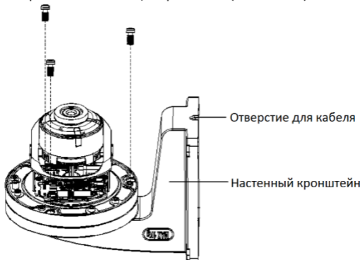
Рисунок 2-11 Установка камеры на настенный кронштейн
