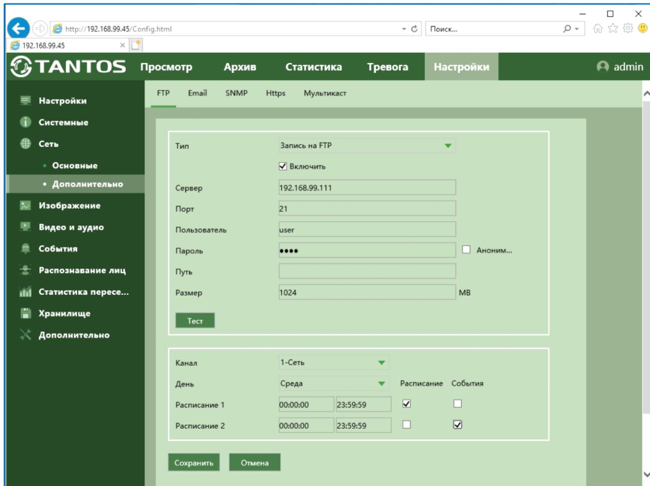
**Тип** – выбор типа записи – запись видео или отправка снимков. Для каждого типа настроек записи можно использовать отдельный FTP сервер.
