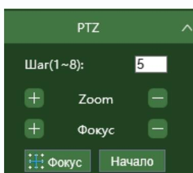
Меню **Управление PTZ** позволяет оперативно управлять поворотными камерами и камерами с моторизованным объективом.
