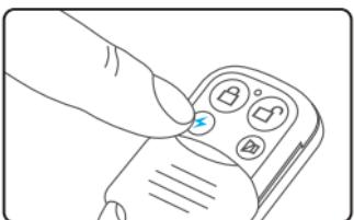
При нажатии кнопки экстренного вызова система переходит в режим аварийной сигнализации независимо от того, в каком режиме находится панель управления.
