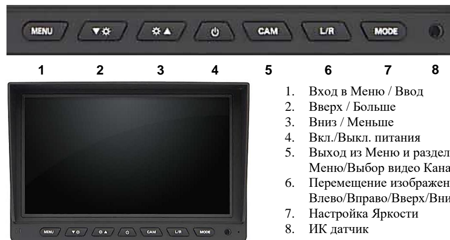
Рис. 2. Вид спереди. Кнопки управления.
