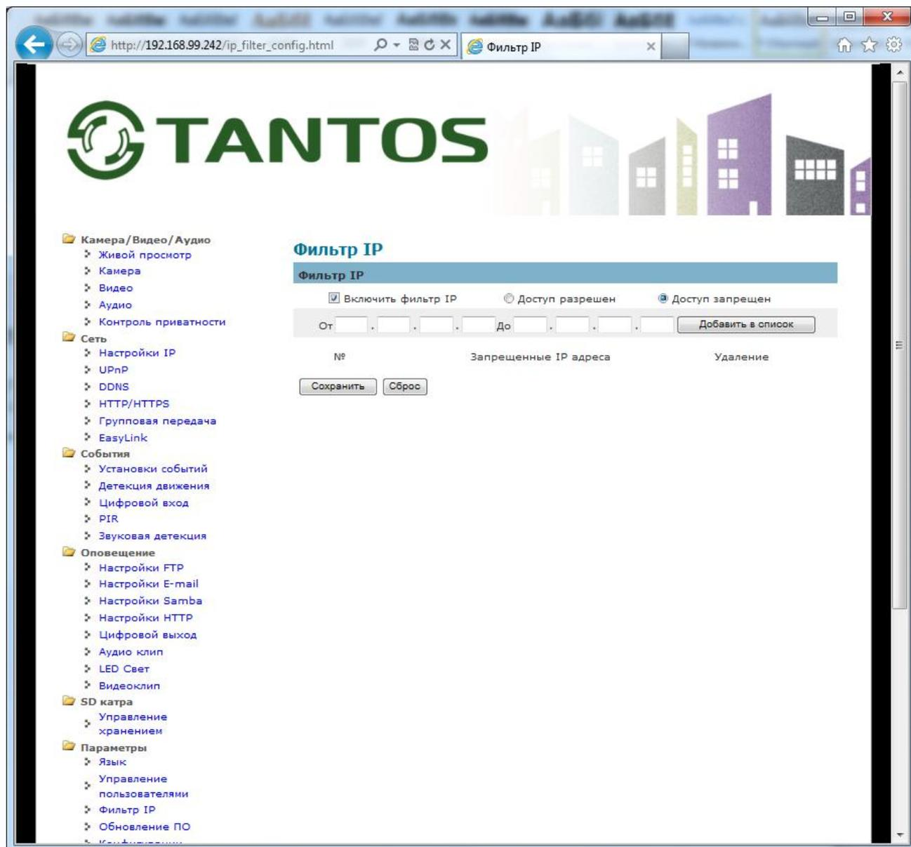
**Доступ разрешен** - диапазон IP адресов, с которых разрешен доступ к IP камере.
