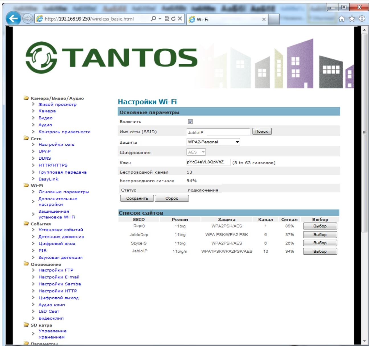
После ввода ключа шифрования нажмите кнопку **Сохранить**. Камера покажет текущий беспроводной канал подключения **Беспроводной канал 13**, силу сигнала **беспроводного сигнала 94%** и статус подключения.
