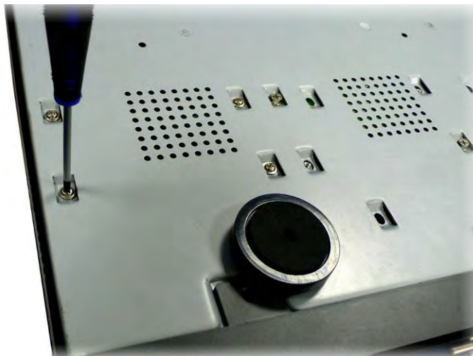
Закрепление жесткого диска винтами
