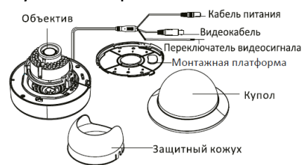
Рисунок 1-13 Купольная камера II типа
