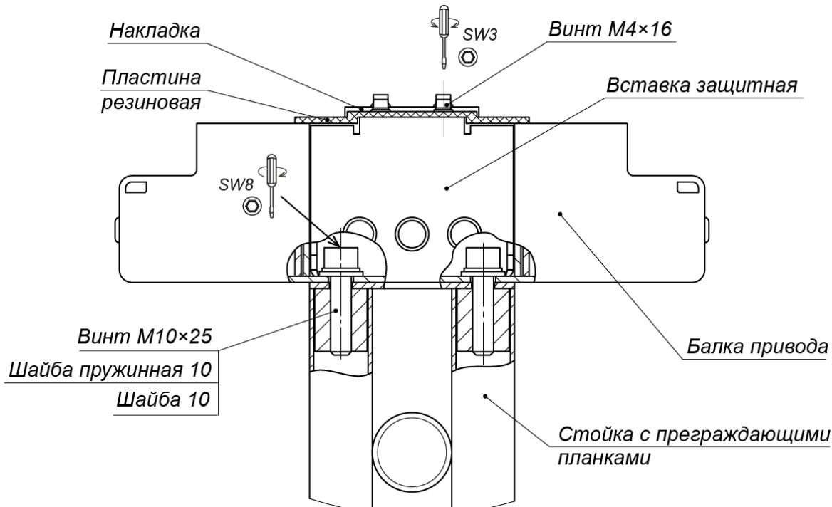
Рисунок 16. Крепление балки привода (8) к стойке с препротяждающими планками (5)
