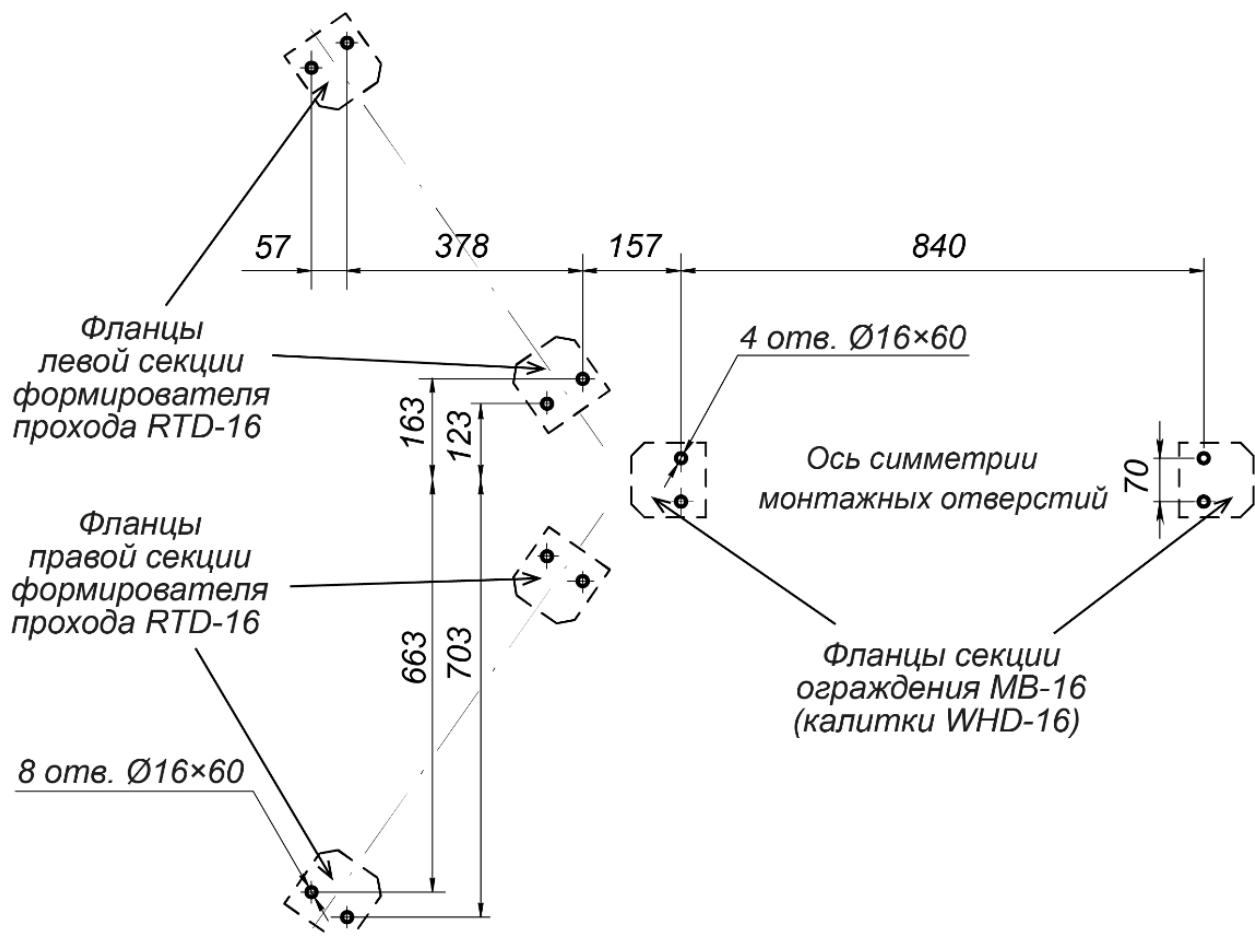
**Рисунок 28. Схема разметки для монтажа турникета с ограждением или калиткой, расположеннымными со стороны секций формирователя прохода..**
