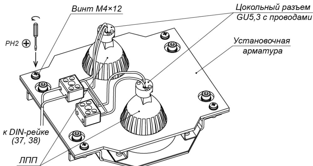
**Рисунок 24. Лампы подсветки прохода с установочной арматурой**
