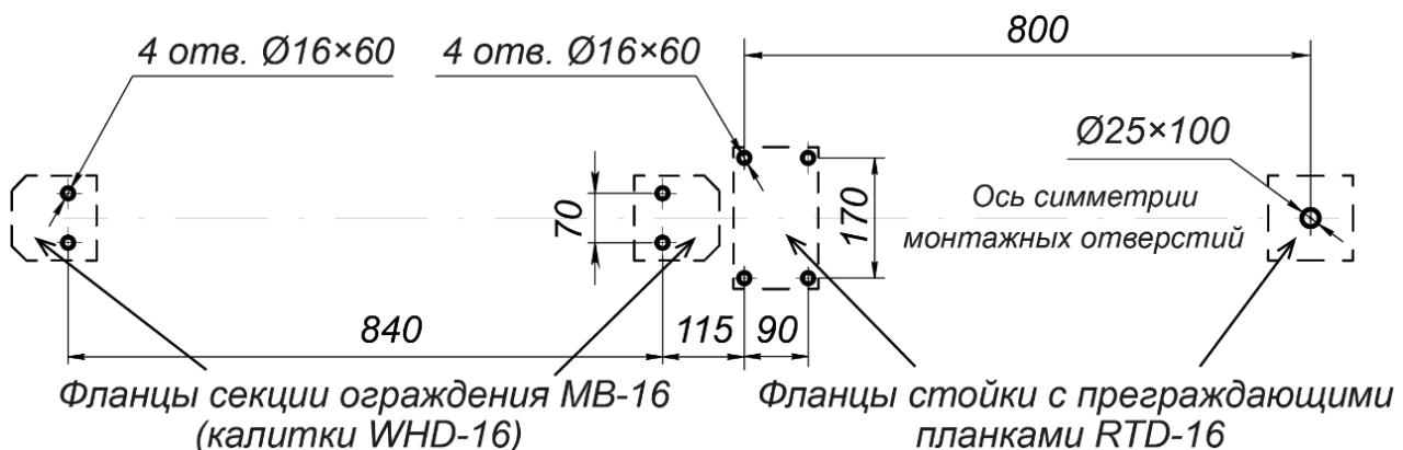
Рисунок 27. Схема разметки для монтажа турникета с ограждением или калиткой, расположенные со стороны стойки с преграждающими планками
