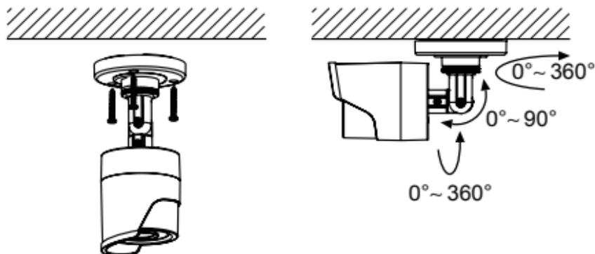
Рисунок 3. Установка камеры TC23W на потолок.
