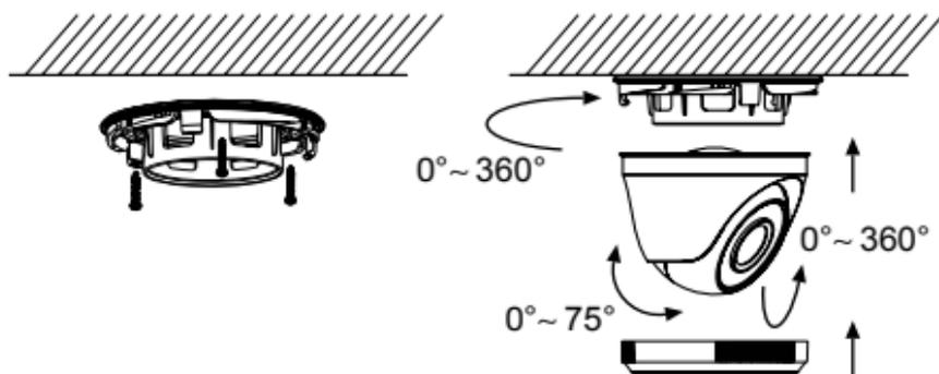
Рисунок 2. Установка камеры TC22W на потолок.
