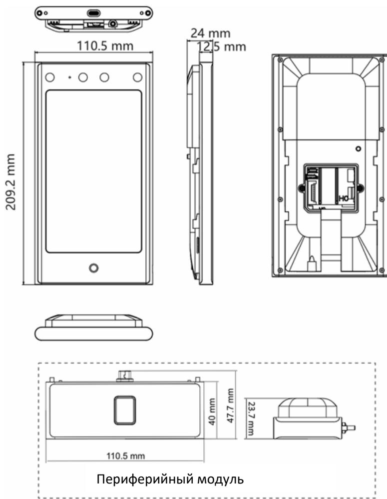
\*Примечания: внешние модули имеют такие же габариты. В качестве примера приведен модуль отпечатков пальцев.
