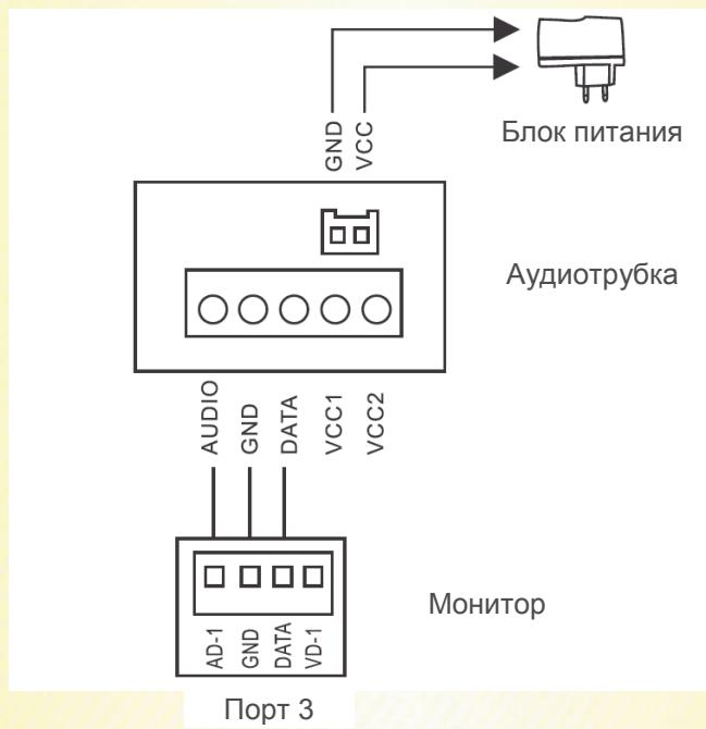
**Примечание:** При питании трубы от внешнего блока питания, подключение питания может осуществляться через коннектор питания или через клеммную колодку.
