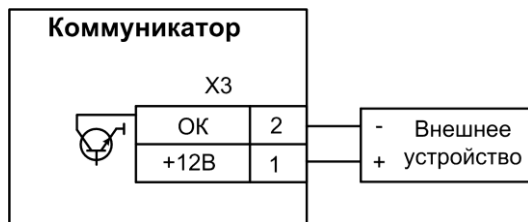
Рисунок 15.2 – Схема подключения внешнего устройства к коммуникатору
