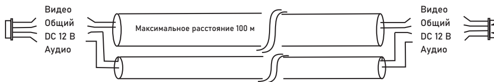
Рис. 18 Комбинированный видеокабель для подключения видеодомофона
