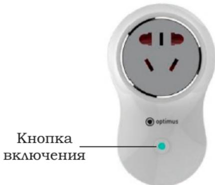
1. После включения розетки индикатор начнет мигать раз в секунду это значит, что начат поиск смарт-шлюза в сети для подключения.
