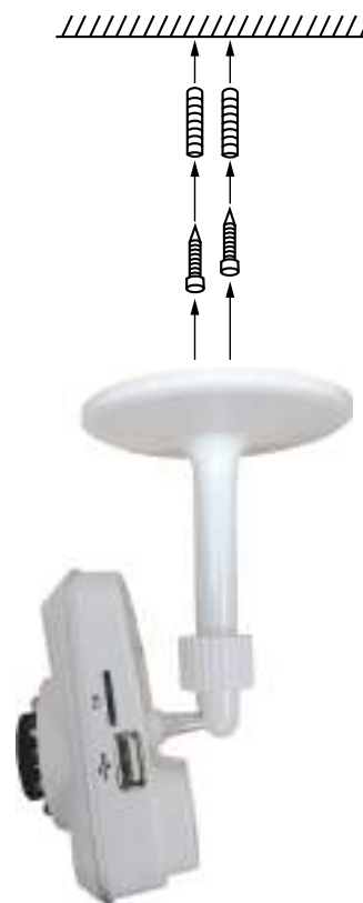
Рис.2.5 Камера установлена на кронштейне.
