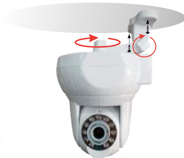
Рис. 2.2 Камера закреплена на кронштейне
