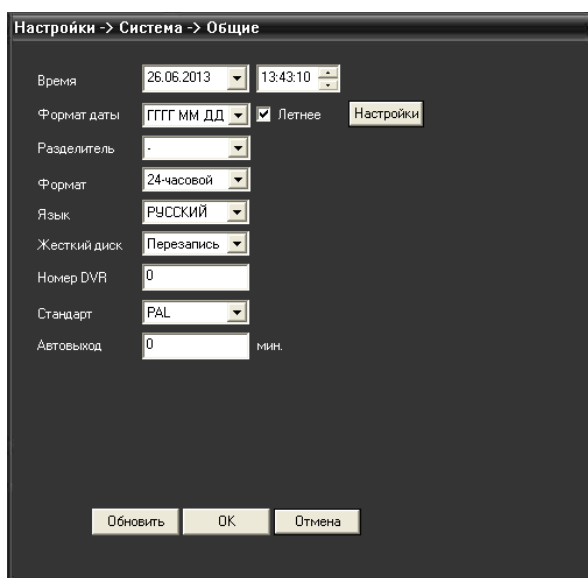
Рис. 3.27 Установка системных параметров.
