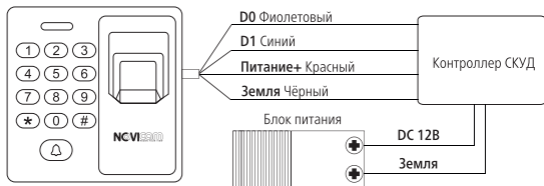
Рис. 3 Подключение SFE15K в режиме считывателя
