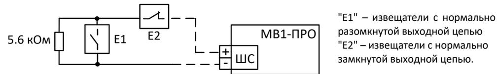
Рис.3. Подключение к ШС извещателей технологической сигнализации
