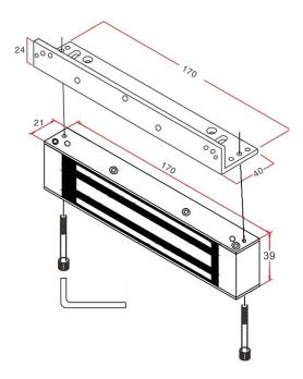
В случае, если ширина дверного проёма недостаточна широка для установки электромагнитного замка CTV Lock-M180, вместо монтажной пластины следует использовать кронштейн Bracket L180 (L-кронштейн). На монтажной схеме показано крепление электромагнитного замка к L-кронштейну. Порядок крепления:
