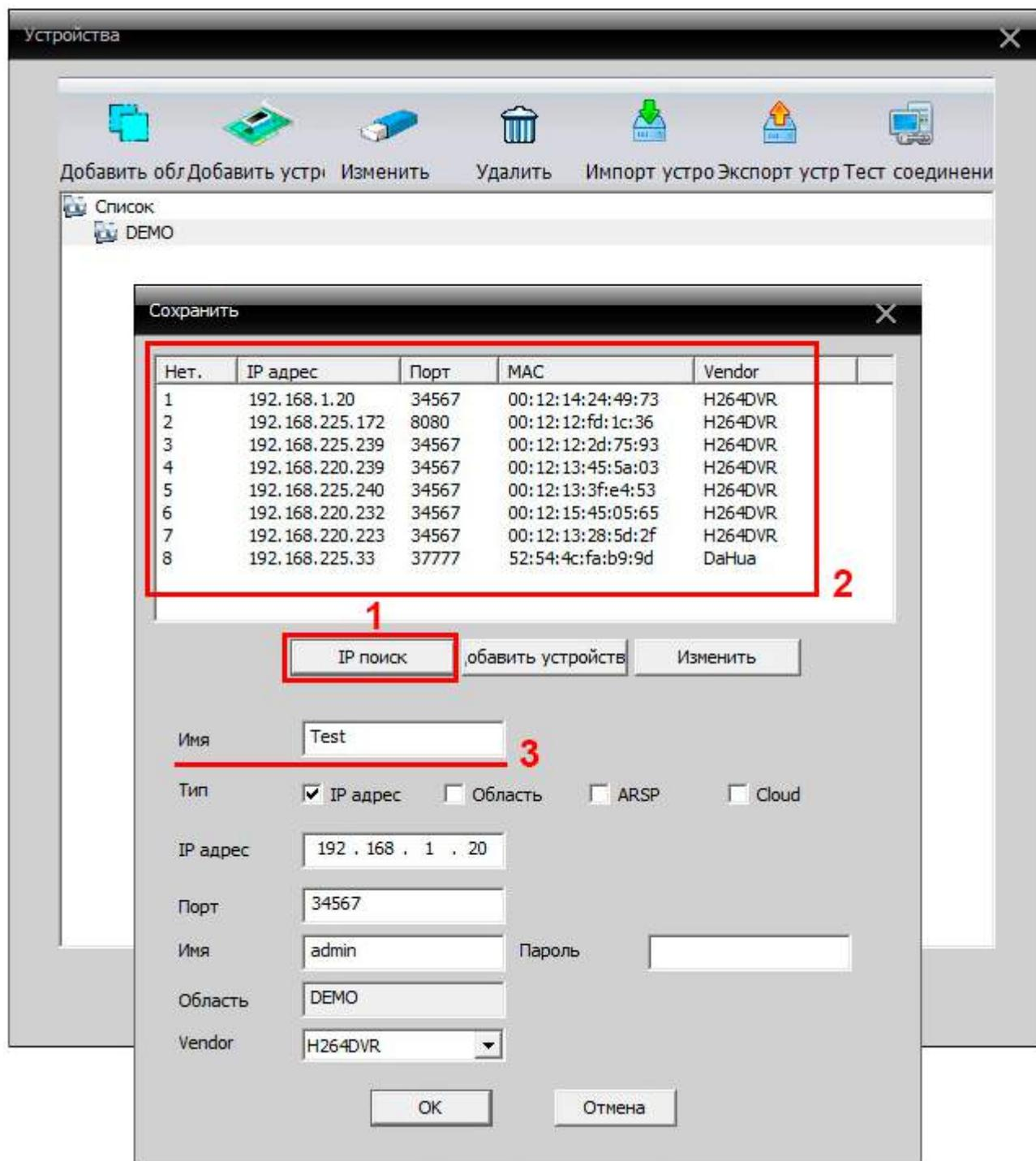
В появившемся окне нажмите кнопку «IP поиск» (1). Программа произведет поиск IP устройств Amatek в локальной сети, к которой подключен компьютер, на котором установлена программа CMS.
