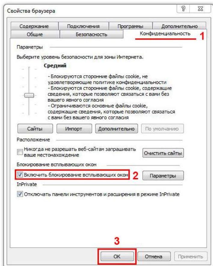
В процессе установки элементов ActiveX в браузере идет диалог с пользователем через всплывающие окна с различными запросами. Что бы данные окна отображались необходимо в браузере снять запрет на всплывающие окна. На примере Internet Explorer необходимо снять галочку «Включить блокирование всплывающих окон» в меню «Сервис/Свойства браузера», закладка «Конфиденциальность» (1), параметр «Включить блокирование всплывающих окон» (2). Сохраните настройки нажав кнопку «ОК» (3).
