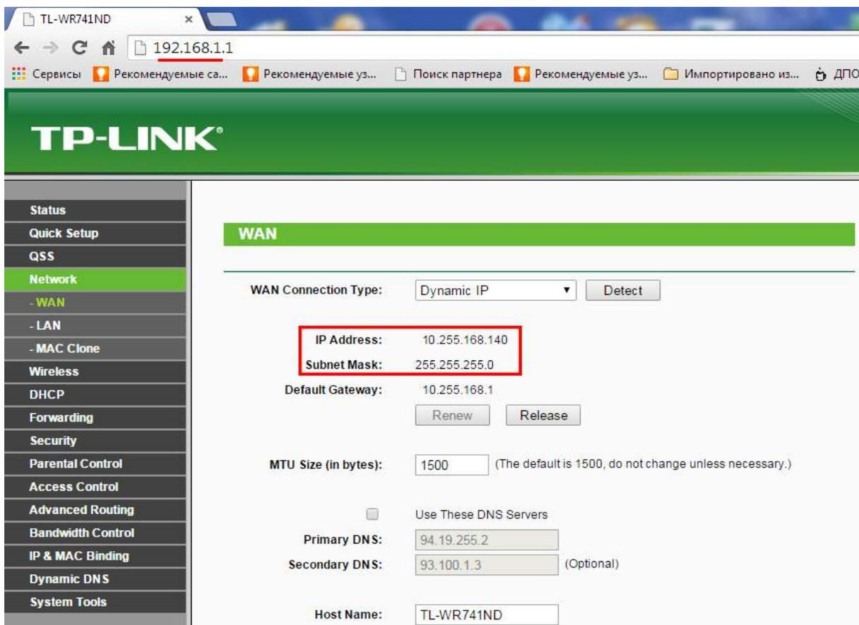
Сделаем предварительную проверку, возможно ли использовать данный IP-адрес для работы с камерой в Интернет. Если внешний IP адрес вашего роутера входит в диапазоны, предназначенные для использования в локальных сетях (описанные выше), то его НЕЛЬЗЯ использовать для работы с камерой через Интернет. В нашем примере приведен «серый» адрес т.к. белые адреса являются собственностью различных компаний, и их использование в обучающих целях запрещено.
