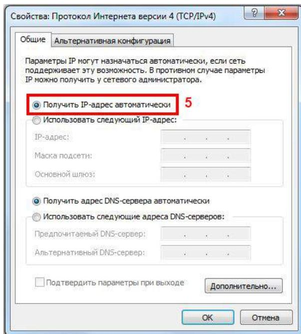
Если в настройках вашего ПК выбрано «Получить IP-адрес автоматически» (5), то в вашей внутренней локальной сети IP-адреса устройства получают при включении автоматически от роутера.
