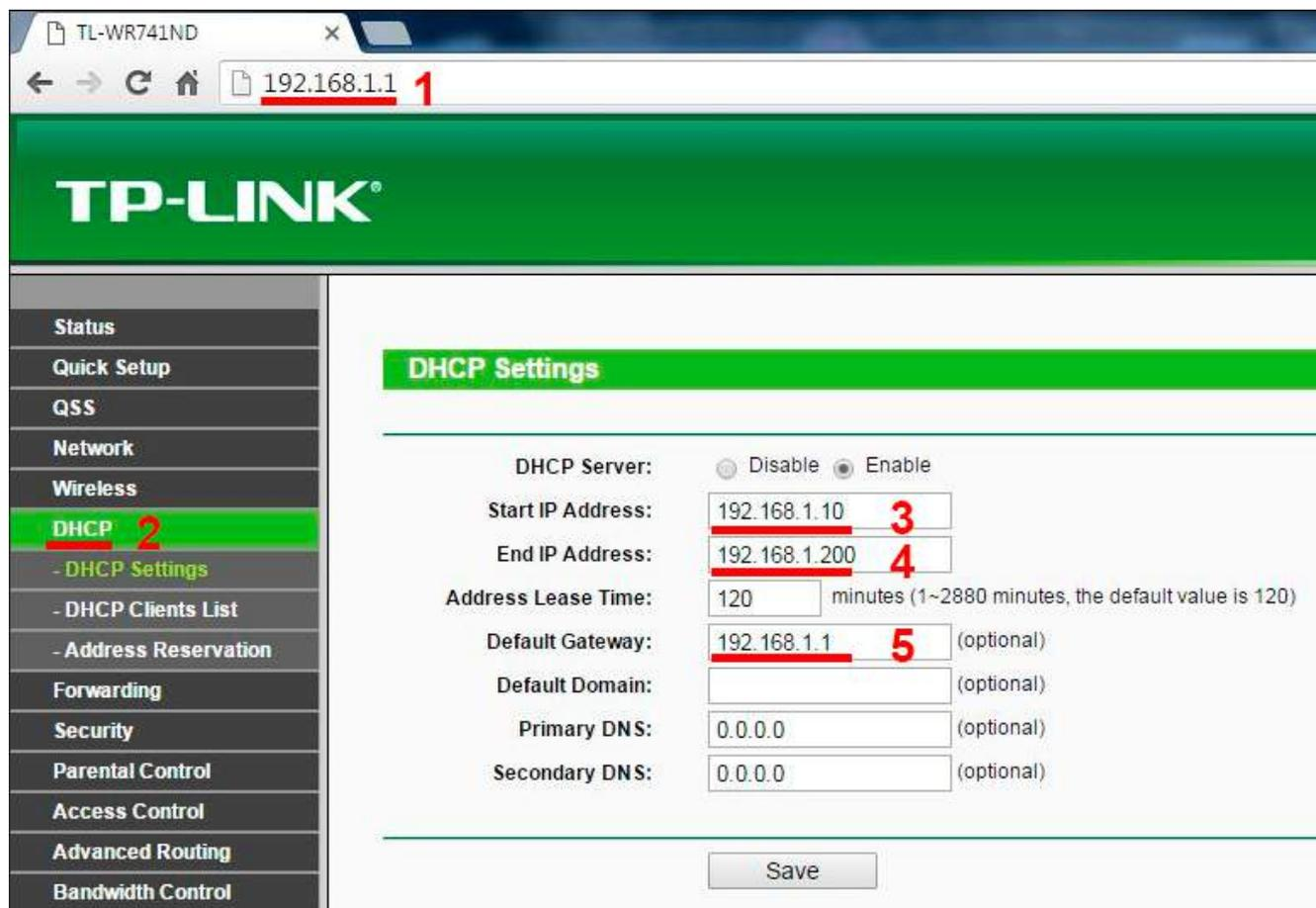
Теперь необходимо выбрать IP-адрес для вашего видеорежистратора. Узнав диапазон адресов, которые Ваш роутер назначает другим устройствам сети можно выбрать (назначить) IP-адрес для видеорежистратора. Его обязательно нужно взять из указанного диапазона. В зависимости от значения параметра «Маска подсети» в адресе изменяется одна или две последние его цифры:
