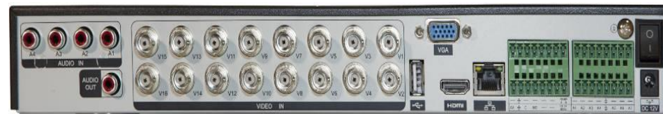
Рис. 1. Расположение разъемов на задней панели Прибора
