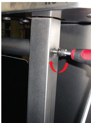
2. Затяните верхний винт
