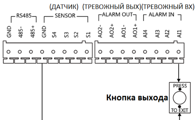
Рисунок 5-20 Подключение кнопки выхода для моделей DS-KD8102-V/DS-KD8002-VM (1)
