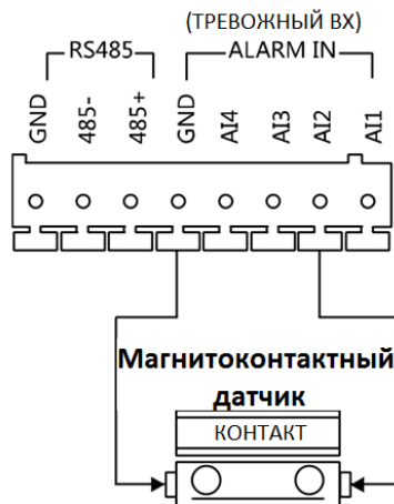
Рисунок 5-19 Подключение магнитоcontactного датчика для модели DS-KD6002-VM
