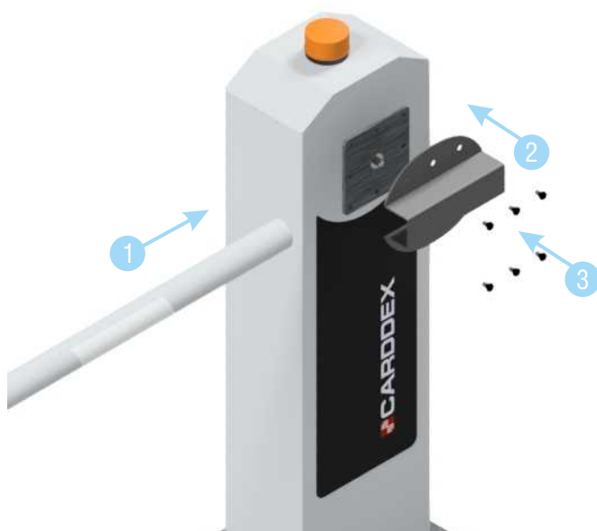
Рисунок 7.4.1 Установка стрелы на шлагбаум
