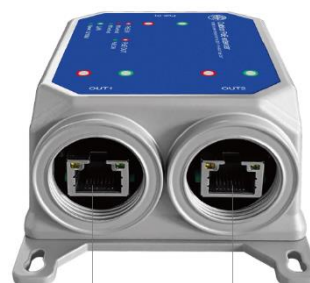
POE OUT 1 Выход Ethernet / POE 10/100M6/c IEEE802.3af/at/bt
