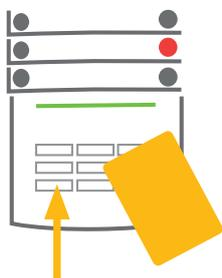
1. Когда Вы входите в здание (срабатывание детектора с реагированием «Зона с задержкой»), система начинает указывать на задержку на вход непрерывным звуковым сигналом и мигающей зеленым светом кнопки сегмента
